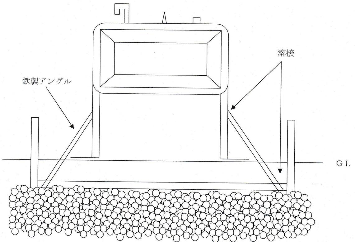
固定例 3 (鋼板型流出防止設備)
